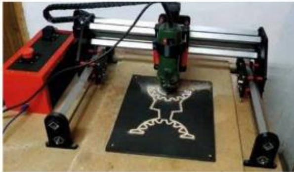
FIGURA 14. Fotografía de la máquina CNC trabajando sobre plancha de madera (Pérez, 2019)
